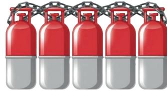
Siempre mantén los cilindros de CO<sub>2</sub> encadenados entre sí, con la cadena tensa y anclada al muro.
